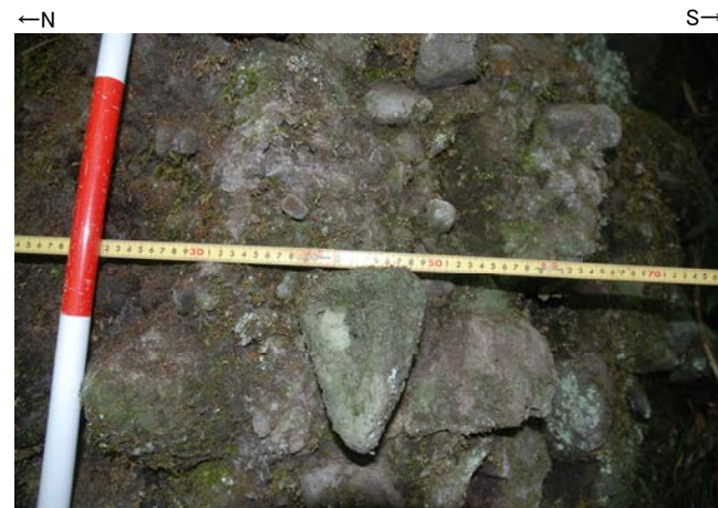
露頭写真①(近景) 凝灰角礫岩からなる
