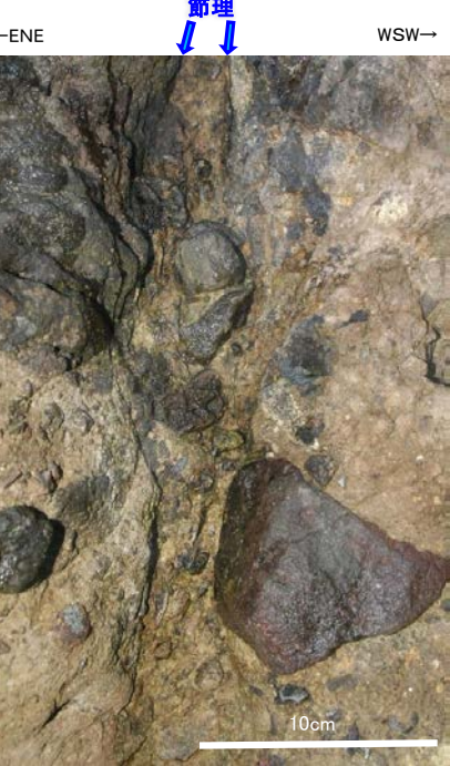
写真①拡大 谷地形(2)と走向が調和的な連続性のよい節理(左:加筆なし, 右:加筆あり)
