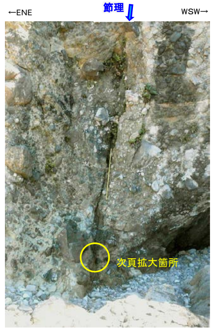
写真① 谷地形(2)と走向が調和的な連続性のよい節理
