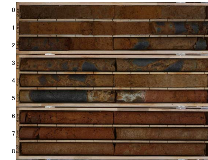
US-N05(孔口標高43.19m, 掘進長9m, 鉛直)
