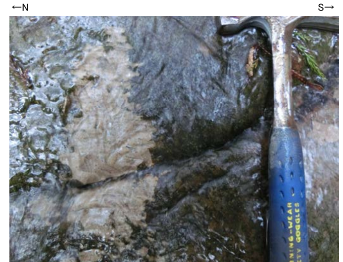
写真④-3 走向N20° Wの節理
