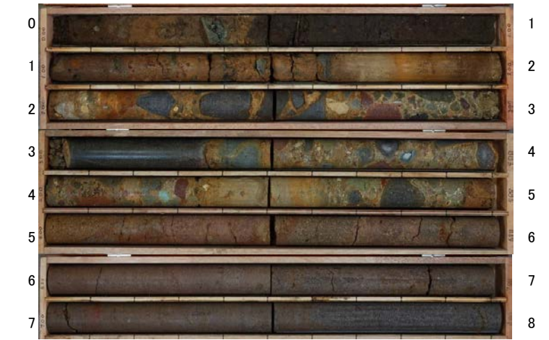
US-N09(孔口標高45.01m, 掘進長8m, 鉛直)
