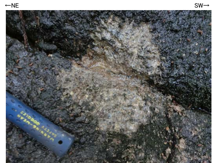
写真⑤-3 走向N75° Eの節理
