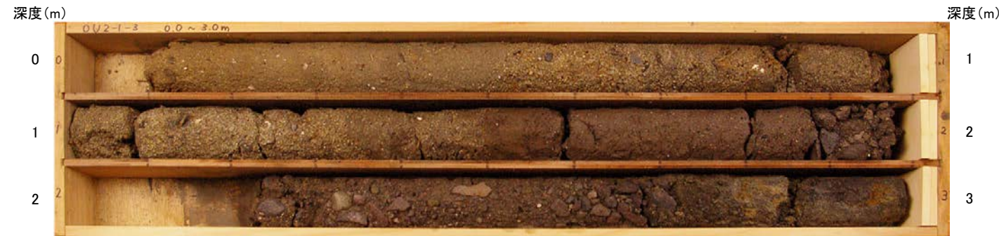
No.2 コア写真 深度0.0～0.1m及び深度2.0～2.22mは, コアサンプラーの打撃により圧縮されているため, 見掛け上コアが欠如している。
