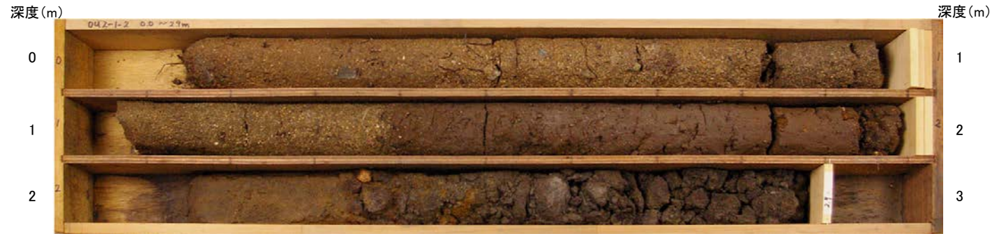
No.1 コア写真 深度0.0～0.15m, 深度1.0～1.05m及び深度2.0～2.15mは, コアサンプラーの打撃により圧縮されているため, 見掛け上コアが欠如している。
