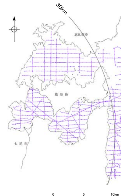
上図凡例 海上保安庁水路部: スーパーカー・シングルチャンネル 七尾湾調査海域の音波探査航跡図※
