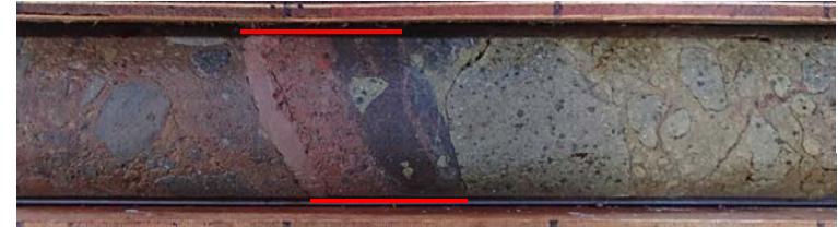
コア写真(FK-1孔, 断層付近拡大)
