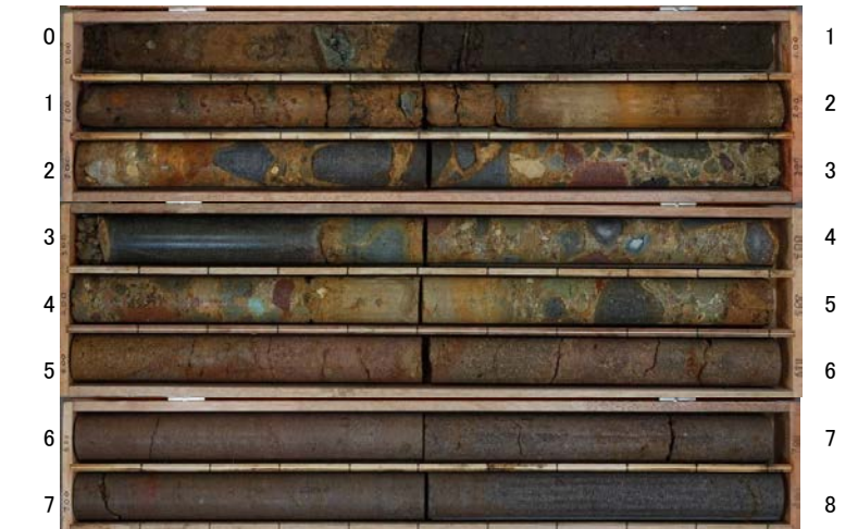
US-N09(孔口標高45.01m, 掘進長8m, 鉛直)
