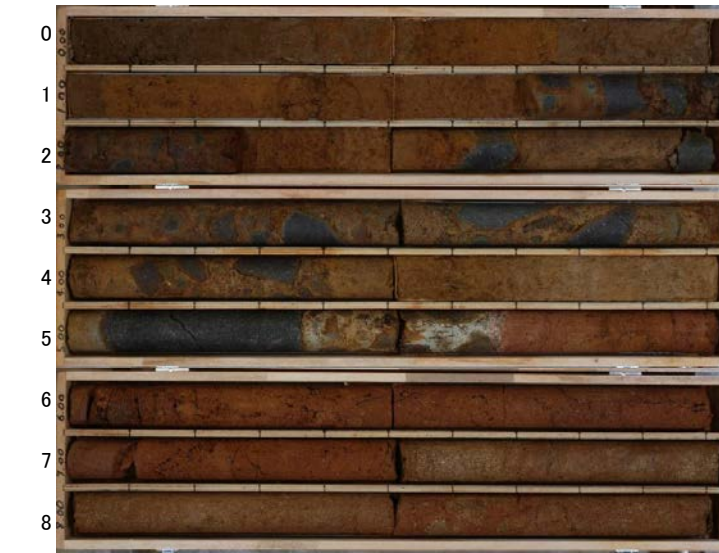
US-N05(孔口標高43.19m, 掘進長9m, 鉛直)
