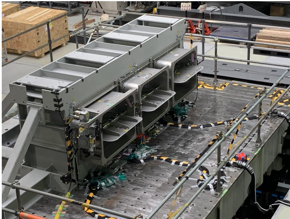
図2 加振試験時の状況写真（3連ダンパ取付時）
