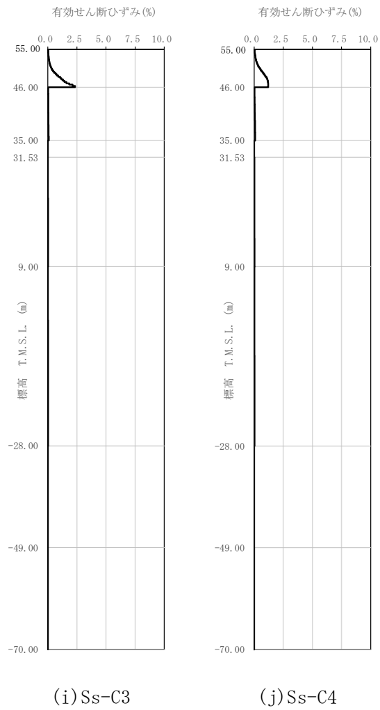
第 3.2.1-4 図 有効せん断ひずみ分布 (3/3) (Ss)
