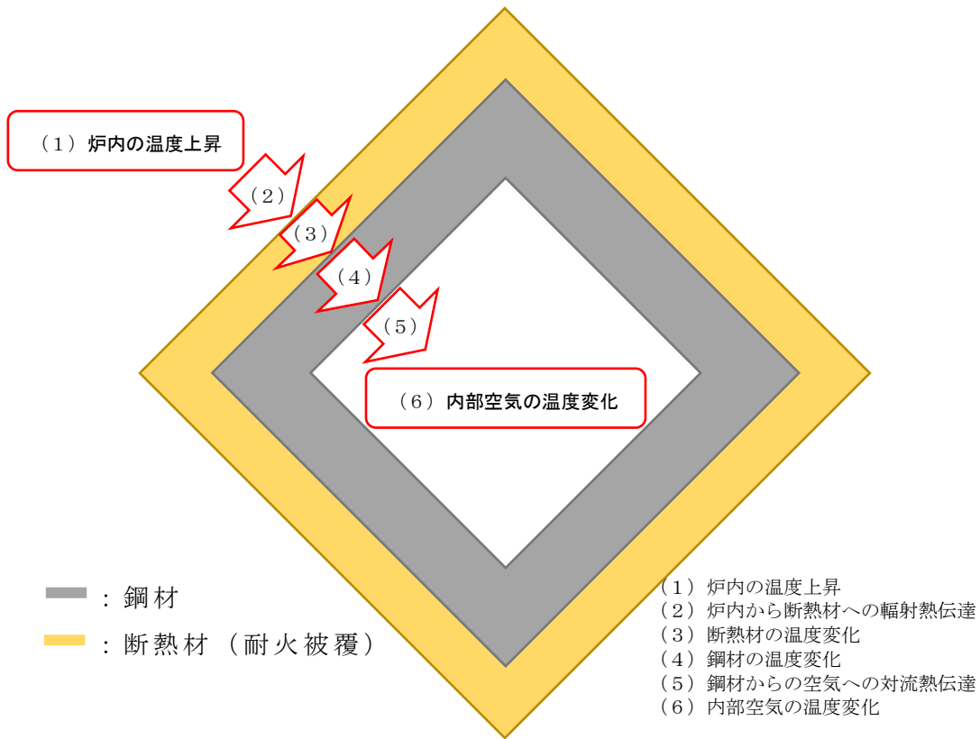
第 1 図 鋼材温度評価の概略図
