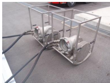
大型送水ポンプ車 水中ポンプ
