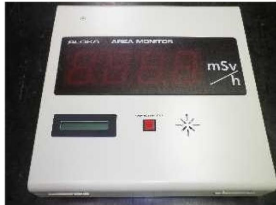
図 61-5-13 可搬型エリアモニタの概略図
