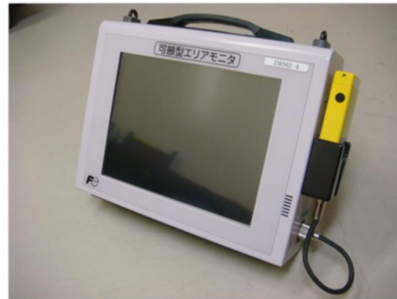
第 61-5-12 図 緊急時対策所エリアモニタの概略図
