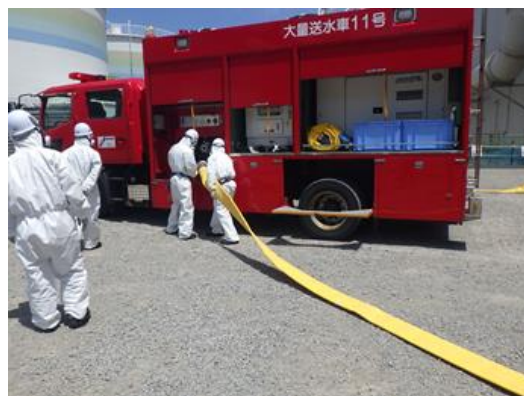
大量送水車へのホース接続 (E L 15m 原子炉建物西側)
