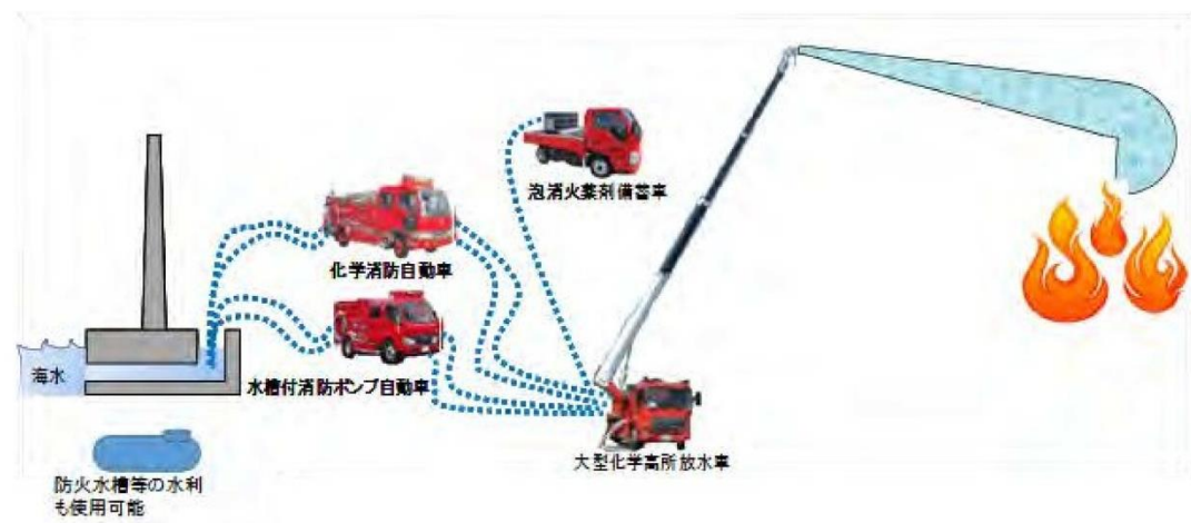
図 8-1 大型化学高所放水車による泡消火
