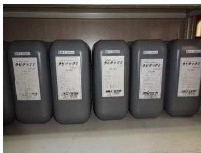
第3図 泡消火薬剤 1000 リットル
