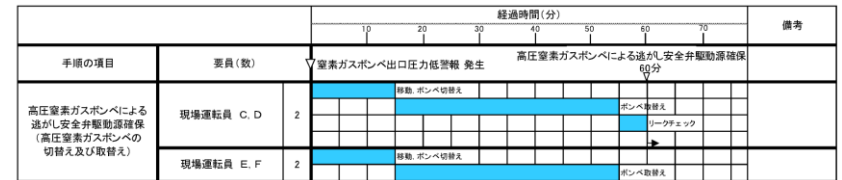
図 3.3-8 高圧窒素ガスポンベによる逃がし安全弁駆動源確保(高圧窒素ガスポンベの切替え及び取替え)のタイムチャート*
