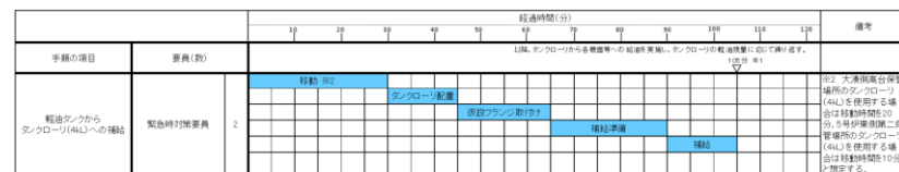
図 3.14-29 軽油タンクからタンクローリ (4kL) への燃料補給のタイムチャート
