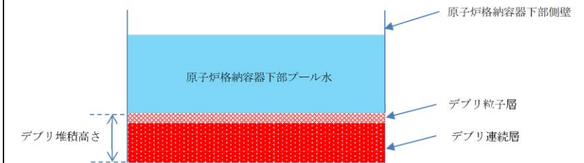
図 3 デブリ堆積高さの概念図
