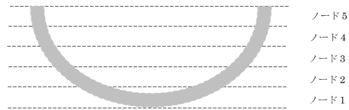
第1図 原子炉压力容器下部ヘッドのノード分割 (概念図)
