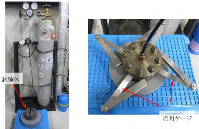
図5 He 気密確認試験状況 図6 He 気密試験時開口模擬 (隙間ゲージ使用)
