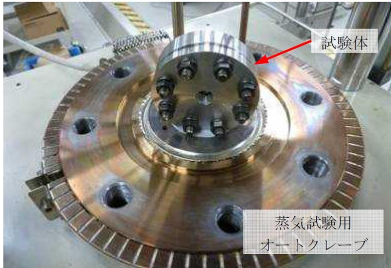
図4 蒸気曝露試験体設置状況
