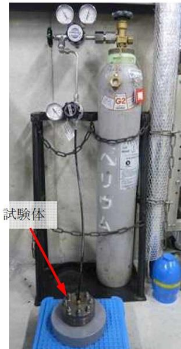
図5 He気密確認試験状況
