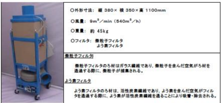
図 3.3-5 可搬型空気浄化装置の仕様等
