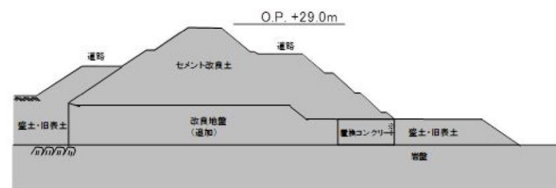
図4.1-4 防潮堤 (盛土堤防) 断面図
