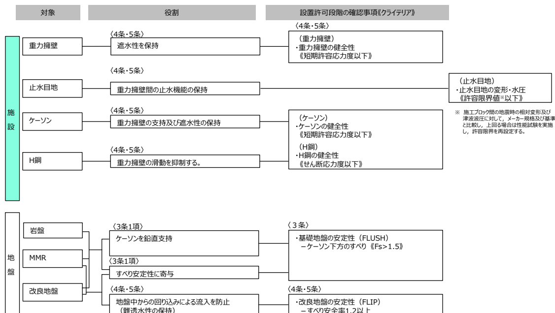
第9-3 図 設置許可段階における確認項目 [防波壁（波返重力擁壁）]
