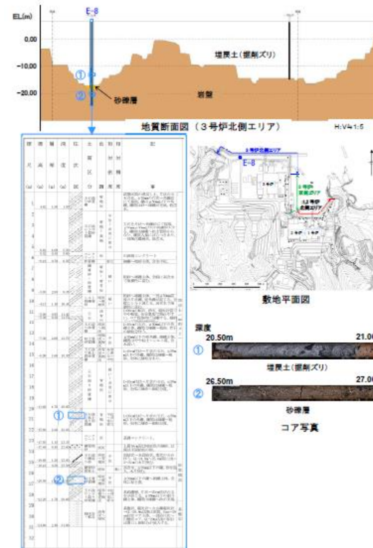
第2-7 図 敷地の地層分布状況 (断面図) (a) 3号炉北側エリア分布図
