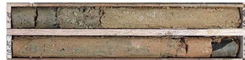
第2-10 図 採取した埋戻土（粘性土）
