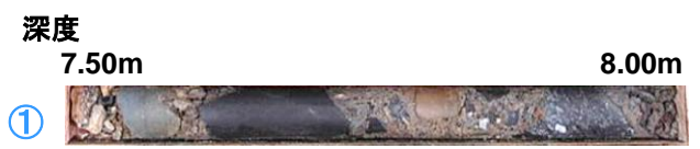
埋戻土(掘削ズリ) コア写真
