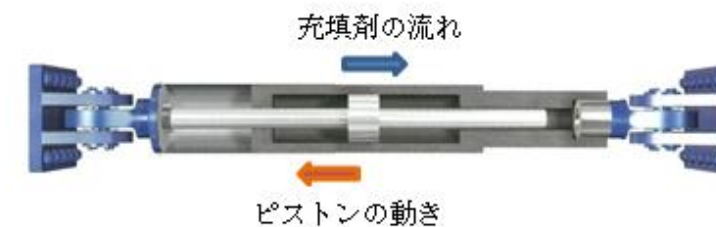
第2-4図 単軸粘性ダンパの動作原理
