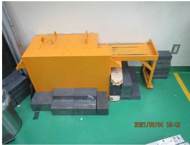
写真 3-1 トリウム保管庫 (1/8inch 厚さ Th I 用) (幅：約 70cm、奥行き：約 40cm、高さ：約 50cm)
