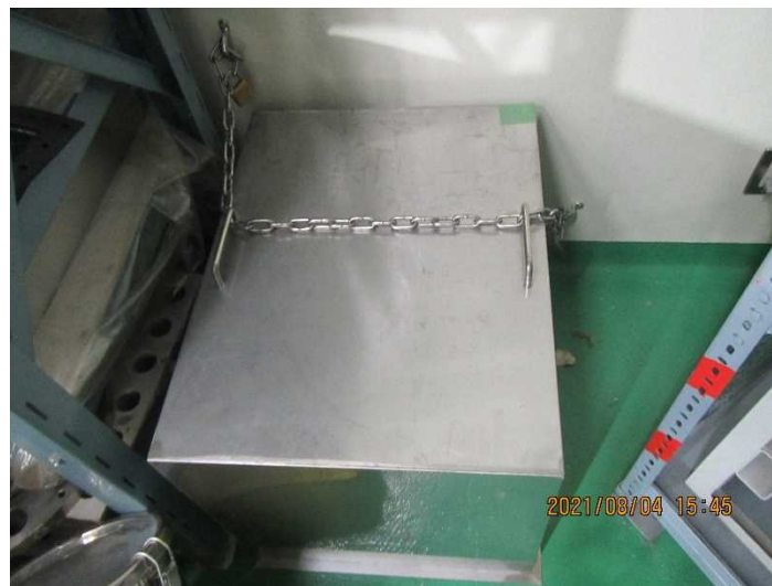
写真 3-2 トリウム保管庫 (1/2inch 厚さ Th II 用) (幅：約 50cm、奥行き：約 65cm、高さ：約 50cm)
