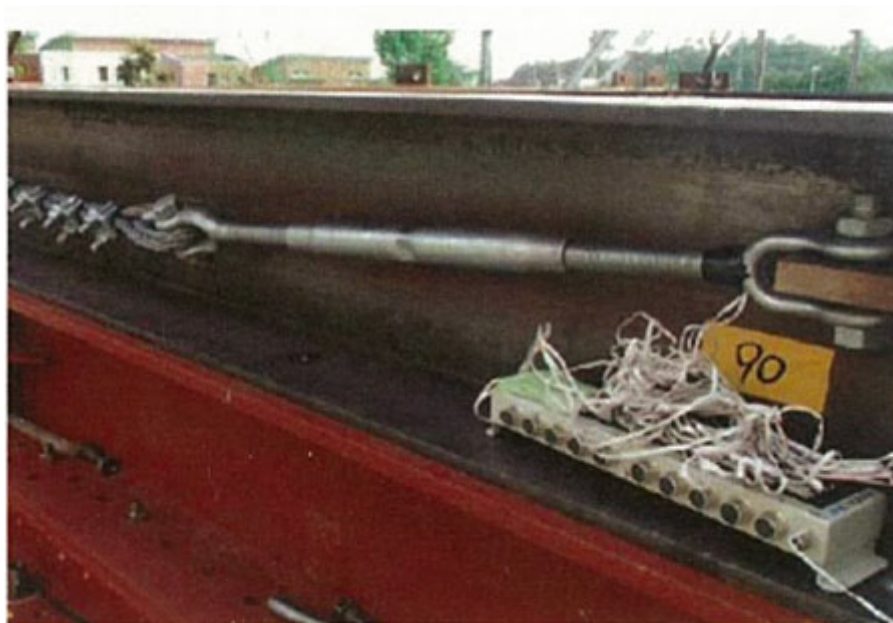
第3-1図 ひずみゲージ付きターンバックルの設置状況
