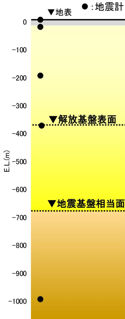
■敷地における解放基盤表面は $V_s$ 700m/s以上となるE.L.-370m位置に設定している。一方、標準応答スペクトルが地震基盤相当面( $V_s$ 2200m/s以上の地層)で定義されていることを踏まえ、敷地における地震基盤相当面から解放基盤表面までの増幅特性を考慮する。
