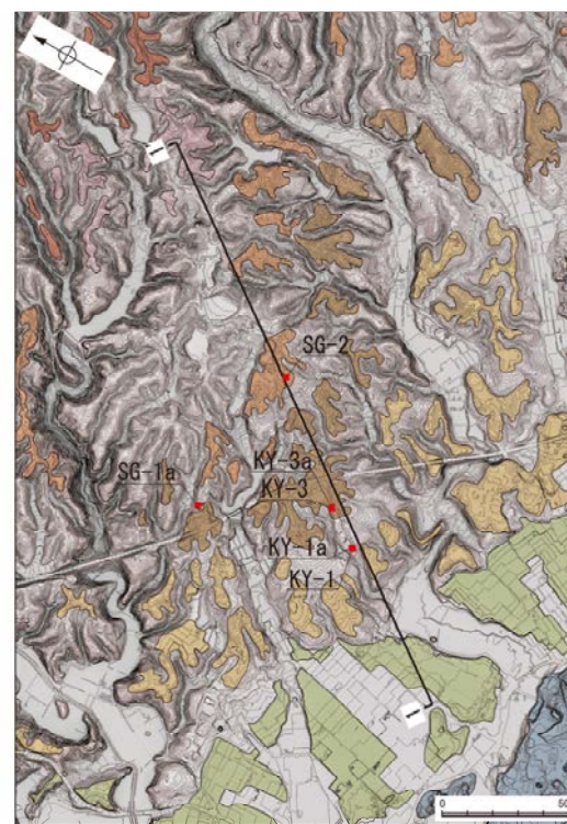
〔調査位置図〕 高位段丘Ⅴ面 高位段丘Ⅳ面 高位段丘Ⅲ面 高位段丘Ⅱ面 高位段丘Ⅰ面 中位段丘Ⅰ面 砂丘 No. 1 調査位置 1' 断面線
