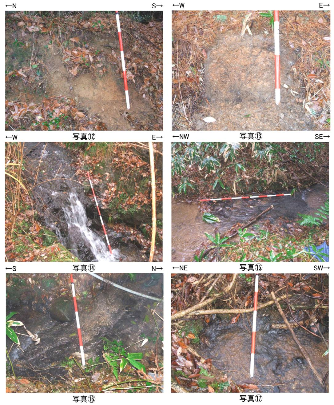
・高ツボリ山東方リニアメントと推定される位置の沢部等で地表踏査を実施した結果、堅硬な穴水累層の安山岩、安山岩質火砕岩(凝灰角礫岩)が広く分布する。
