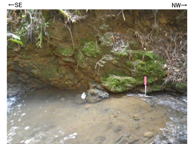
露頭写真② 風化した安山岩が分布し、断層は認められない
