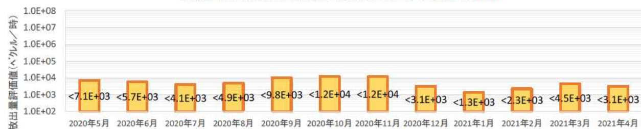
2号機 原子炉建屋, PCVガス管理システムからの放出量推移
