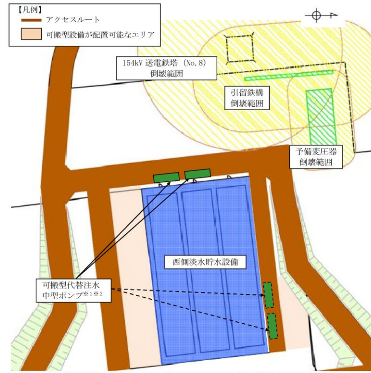
第5図 西側淡水貯水設備から取水する時の可搬型設備の配置イメージ
