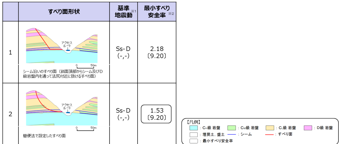
第7.3-10図 すべり安定性評価結果
