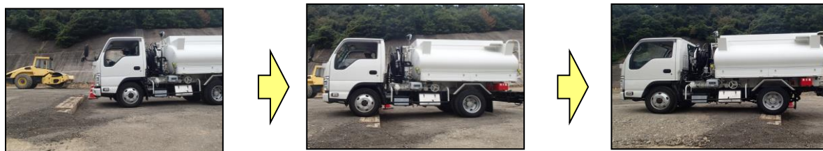
第2図 段差復旧前の走行性能検証(2 / 2)
