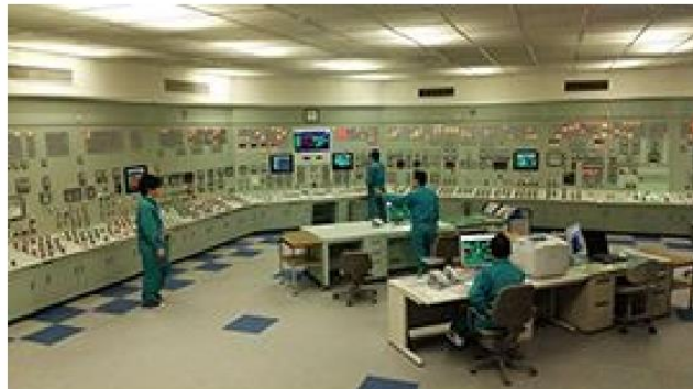
シミュレータを用いた運転操作訓練の状況 （写真は自社施設での実施状況，全交流動力電源喪失時を想定）
