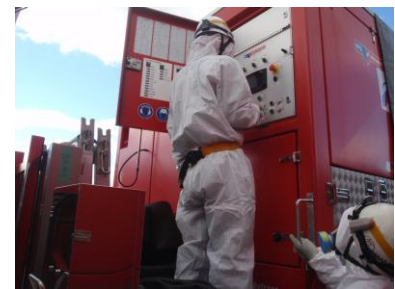
ポンプ起動操作
