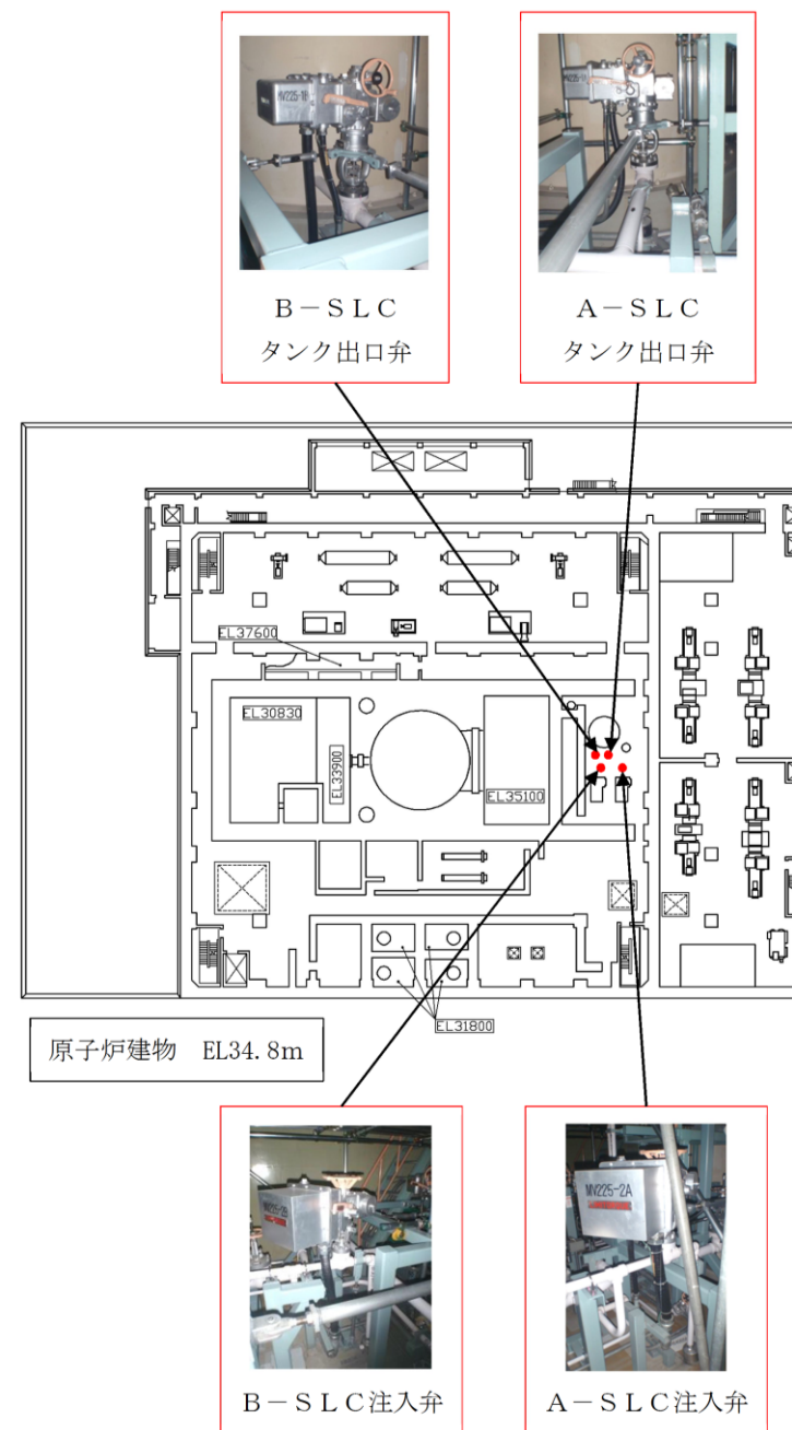
図5 ほう酸水注入系に係る機器（弁）の配置図
