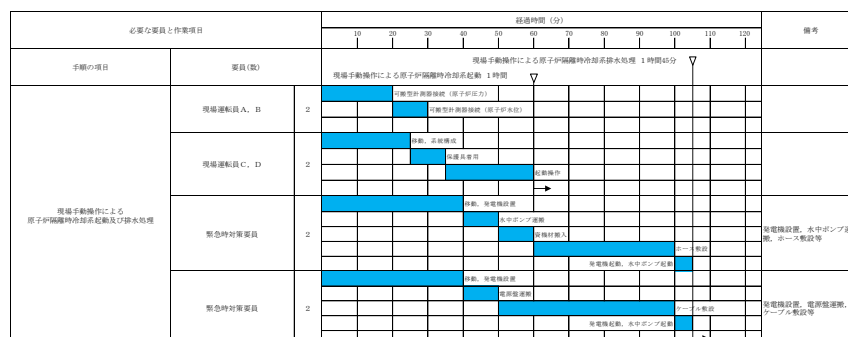
図3.2-6 現場手動操作による原子炉隔離時冷却系起動のタイムチャート*
