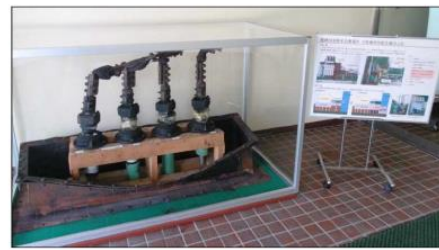
柏崎刈羽3号炉 所内変圧器の火災
