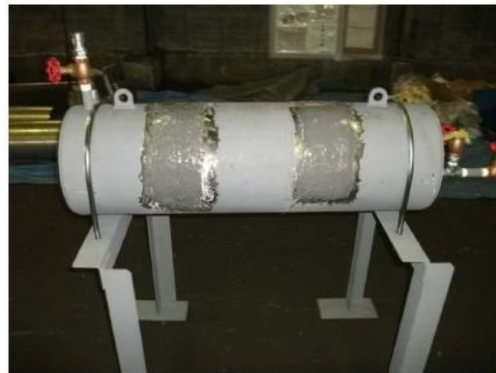
図 2. 1. 2-6 ベロメタル補修後の耐圧試験
