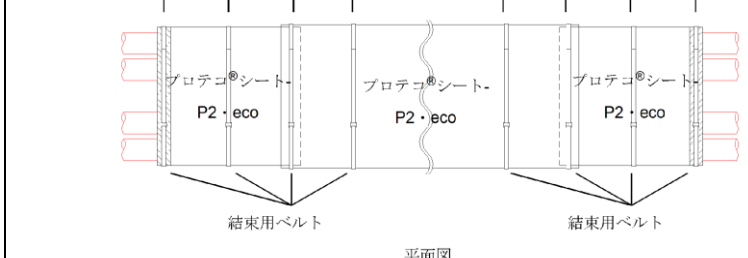
第2図 結束用ベルトの標準的な取付方法（※の資料から抜粋）
