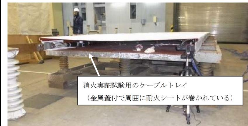
第 3 図 消火実証試験用のケーブルトレイ外観 (金属蓋付で周囲に耐火シートが巻かれている)
