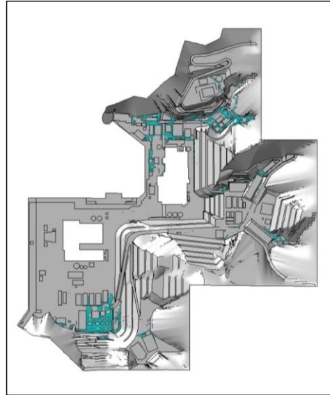
図 10-3-2 屋外タンクの溢水伝播挙動 (1/2)
