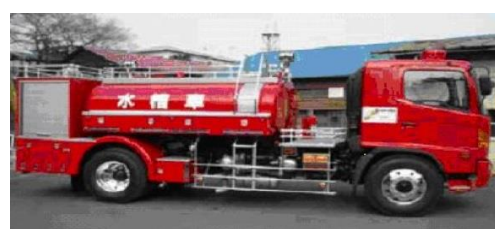
第2図 小型動力ポンプ付水槽車
