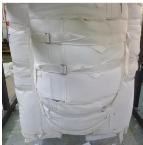
第18図 耐火ラッピングの固定状況
