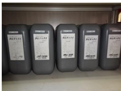
第3図 泡消火薬剤 1000 リットル
