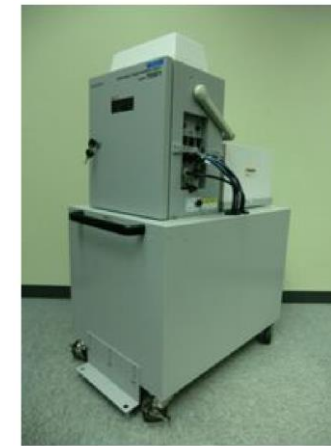
第2.3.3-1図 可搬式モニタリング・ポスト
