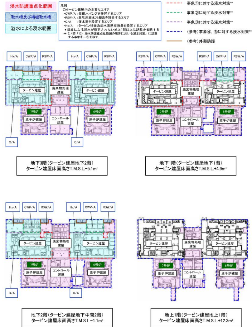
添付第 14-3 図 貫通部止水処置及び床ドレンライン浸水防止治具の実施範囲 (横断面)
