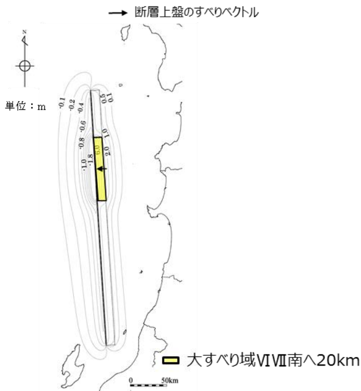
第 1.5-6 図 (7) 地殻変動量分布図：基準津波 6
