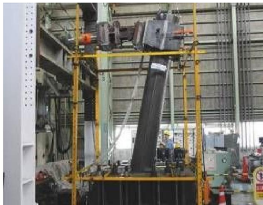
第 5-38 図 最大荷重時座屈状況
