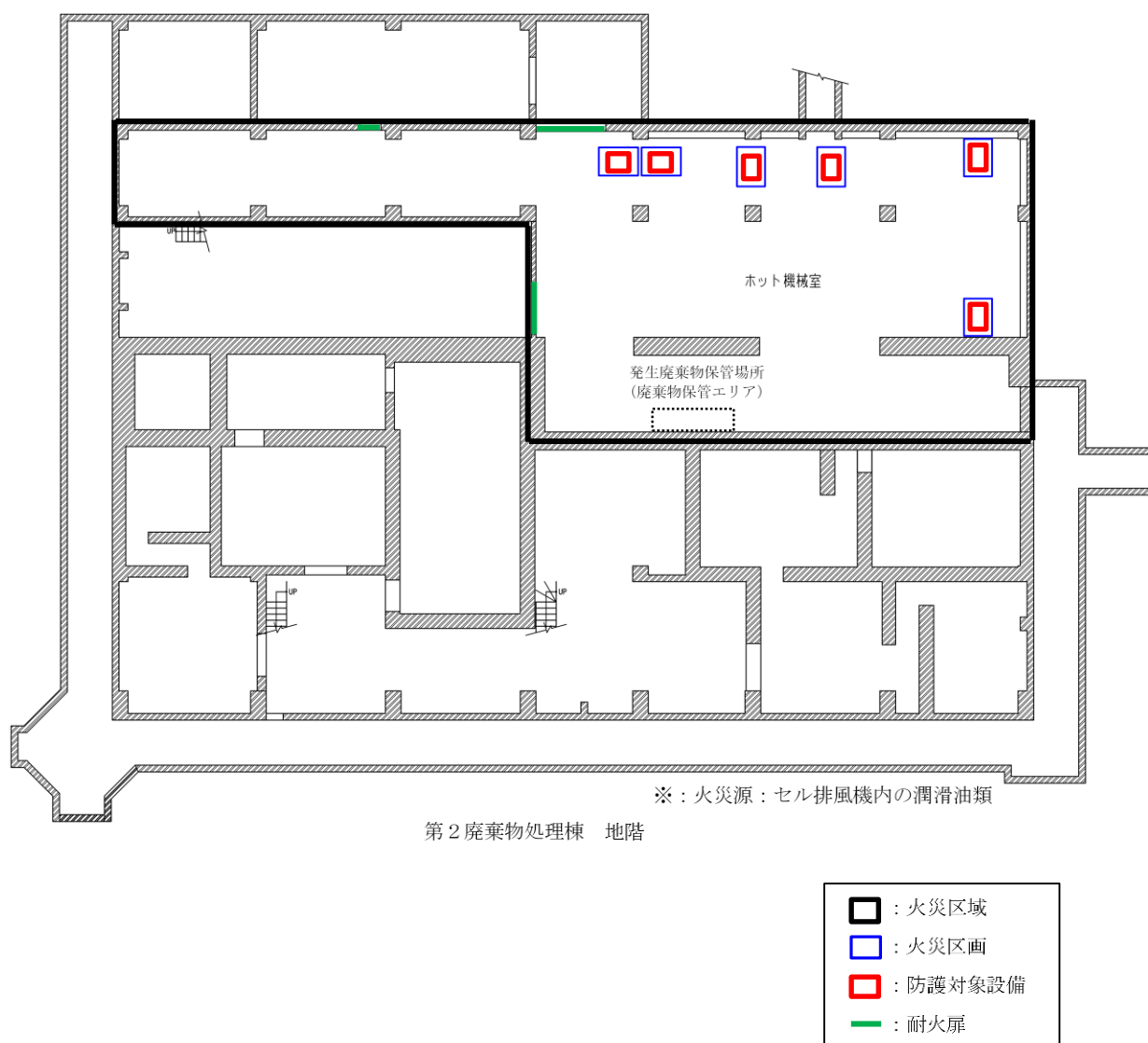
図-1 火災区域、火災区画及び防護対象設備（セル排風機）の位置関係
